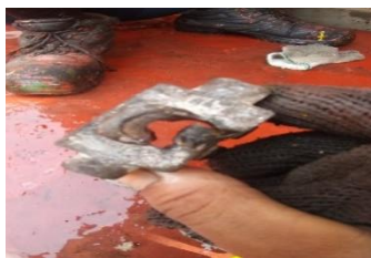
Gambar 4.3. Contoh kerusakan pada bagian twistlock
