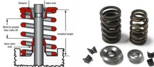
**Gambar 3.** komponen *spring retainer valve*
