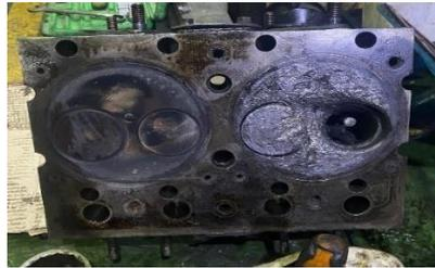
**Gambar 5.** Gambar *Cylinder Head* Yang Mengalami Kerusakan
