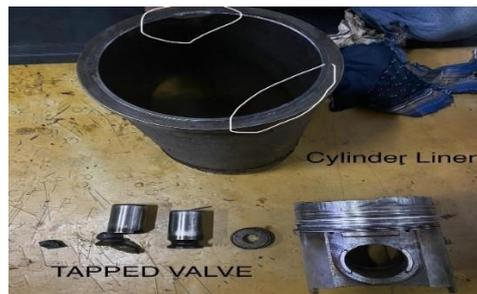
**Gambar 6.** Rusaknya *Tapped Valve* Dan *Cylinder Liner*
