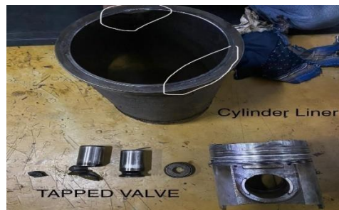
Gambar 6. Rusaknya Tapped Valve Dan Cylinder Liner
