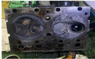
Gambar 5. Gambar Cylinder Head Yang Mengalami Kerusakan
