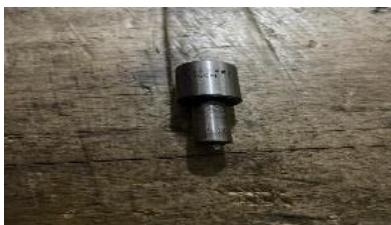
Gambar 3. Kondisi nozzle yang rusak
