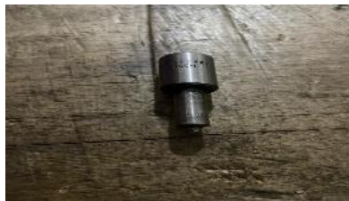
Gambar 3. Kondisi nozzle yang rusak
