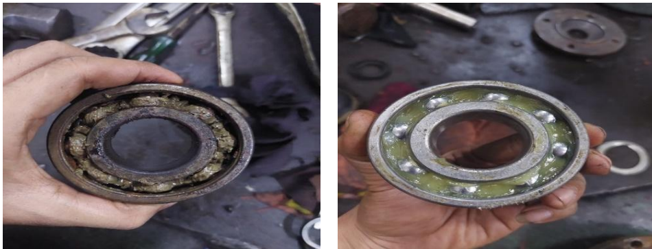
Gambar 2. Kondisi bearing aus dan baru
