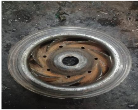
Gambar 1. Impeller yang terkikis
