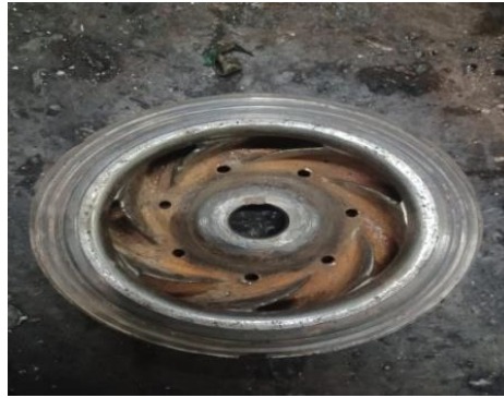
Gambar 1. Impeller yang terkikis
