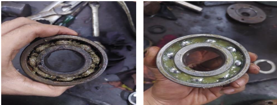
Gambar 2. Kondisi bearing aus dan baru
