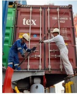
**Gambar 1.** Mengajari cara lashing kepada kru yang baru join di kapal kontainer
