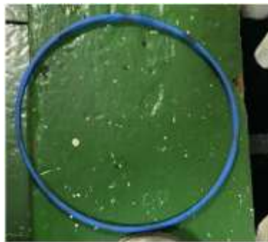
Gambar 2. Kerusakan pada Main Seal Ring
