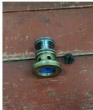
Gambar 9. Pilot Valve Setelah Dilakukan Pembersihan
